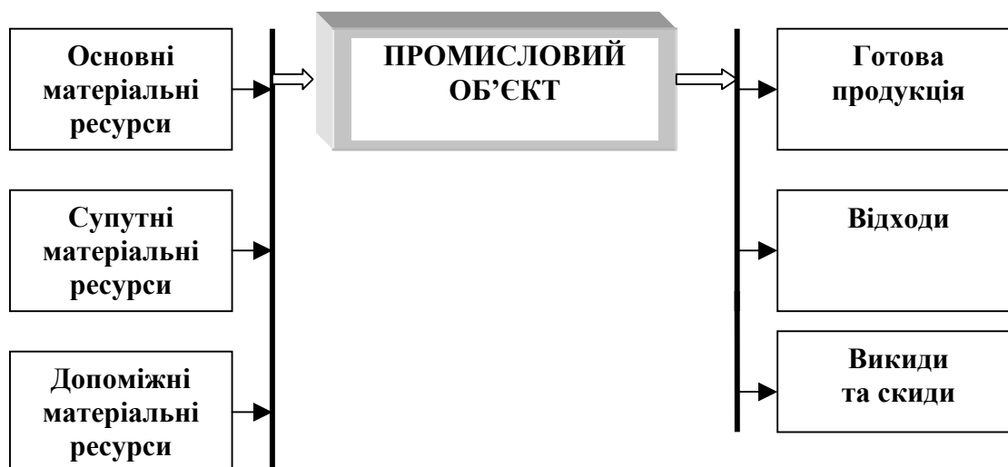
Рис. 1.4. Схема матеріального балансу промислового виробництва
