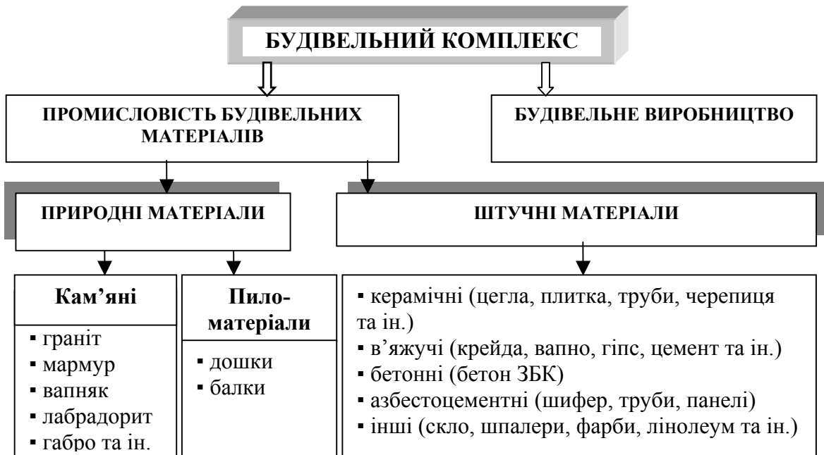
Рис. 11.1. Структура будівельного комплексу
